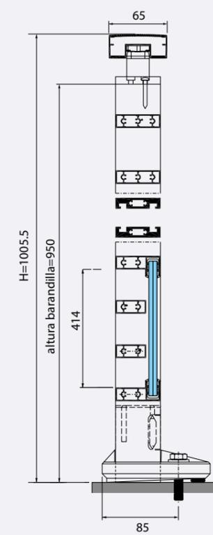
Remplissage tiges inox toute hauteur avec soubassement verre et main courant déportée
